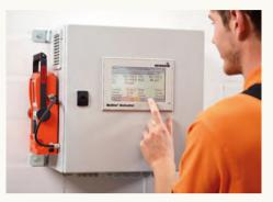
La combinación de los modelos MultiTec 545 y BioControl 4 o BioControl 8 permiten la medición programada y automática en hasta 8 puntos de una planta de biogás. Las mediciones se registran automáticamente y pueden ser accesibles vía remota. También es posible que el sistema tome decisiones y, por ejemplo, proceda al apagado de los generadores en caso de riesgos para la planta.
