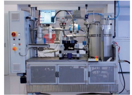
Banco de pruebas electrostático de HYDAC.
