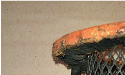
Filtro de ventilación quemado debido a una explosión en el depósito.
