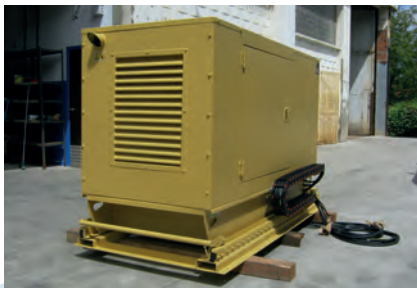
Grupo electrógeno con sistema de rail extraíble para facilitar el mantenimiento
