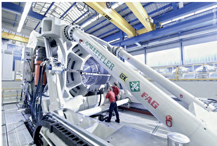
Desde su puesta en marcha en 2011, ASTRAIOS, el banco de pruebas para rodamientos grandes de Schaeffler, ha suministrado información importante sobre características que no se habían podido probar anteriormente, tales como obturaciones y sistemas de lubricación, funcionamiento (influencia de la temperatura y de los tornillos de conexión) y velocidad del rodillo.
