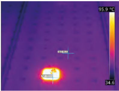
Imagen 1: Imagen termográfica de un Hotspot (Fuente: Flir).
