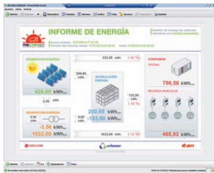
Izquierda: informe mensual de flujos energéticos del proyecto generado por el sistema de monitorización basado en Power Studio Scada. Derecha: informe mensual de consumos y emisiones ahorrados del proyecto RECARGO.
