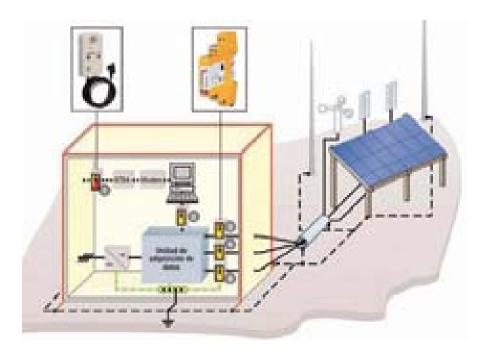
largo de la vida útil de una planta solar, visualizando el funcionamiento del sistema y verificando que funciona siguiendo los parámetros con los que fue diseñada, pudiendo tener un control diario de la facturación energética. Se facilita en gran medida el mantenimiento del sistema fotovoltaico al poder detectar de forma rápida los fallos o alteraciones y subsanarlos, lo que permite optimizar el rendimiento de la planta solar.
